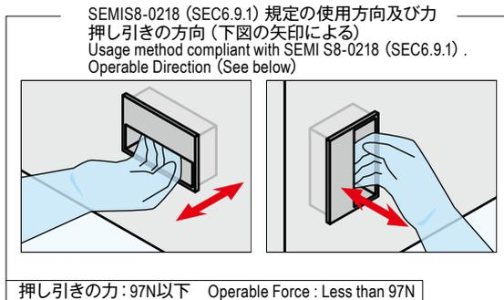
押し引きの力 : 97N以下 Operable Force : Less than 97N
